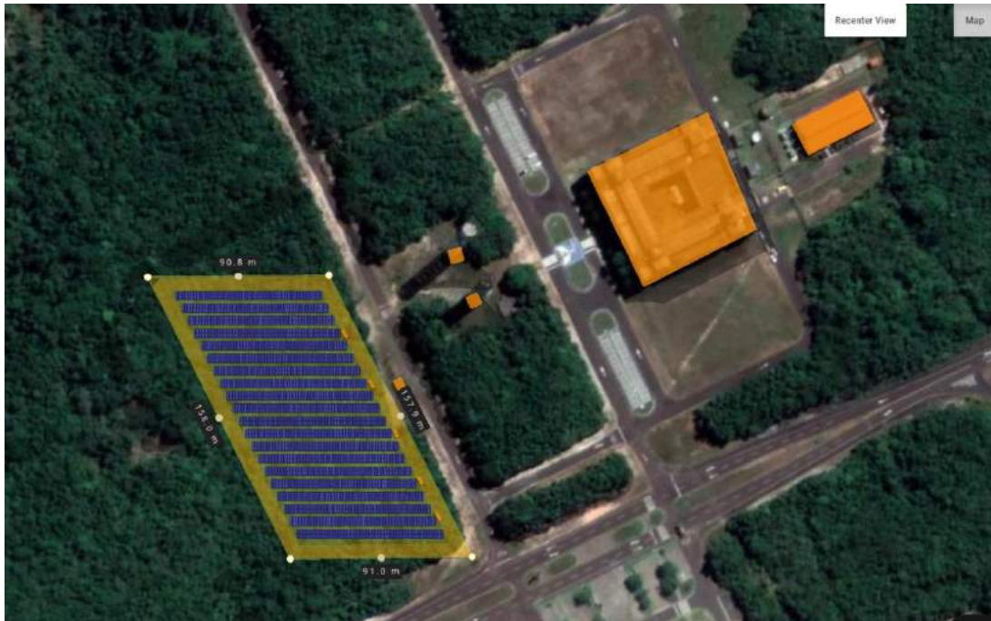
Figura 1 – Vista aérea da área do CLA na qual será instalada a microrrede, sendo indicada a localidade da planta fotovoltaica que serve de referência para a locação do BESS.
